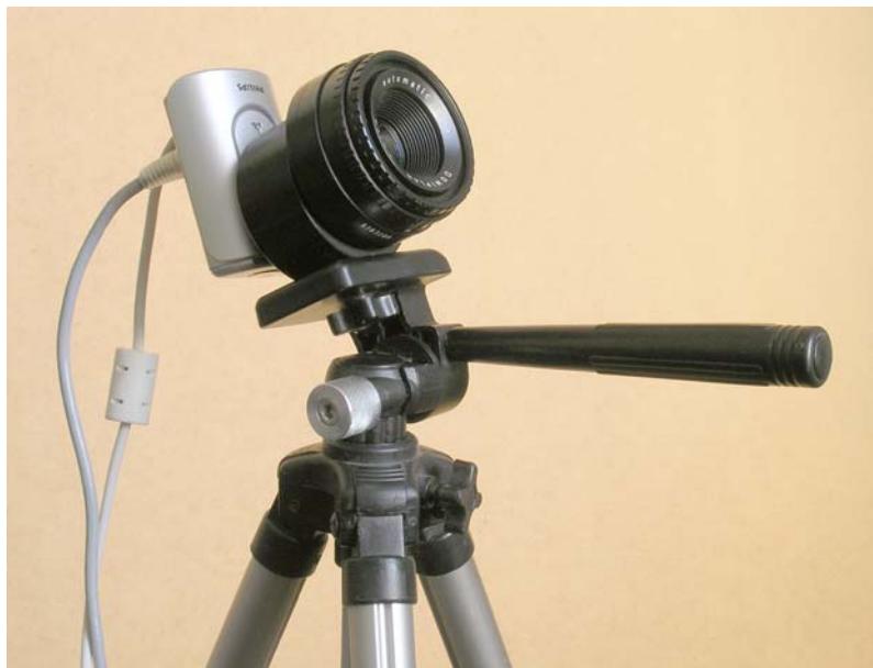
Kamera Philips ToUcam PRO II z obiektywem Domiplan 2.8/50 podłączonym poprzez nową wersję przejściówki. Rączka statywu znajduje się z przodu układu, w przeciwnym razie utrudniałaby obserwację obiektów znajdujących się wysoko nad horyzontem.
