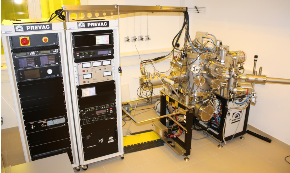
Rys.21. Napylarka elektronowa z działem jonowym dla litografii elektronowej. Próżnia podstawowa 2 \cdot 10^{-9} mBar (bez wygrzewania). System umożliwia napylanie cienkich warstw pod różnymi kątami.
