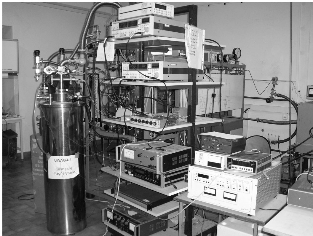
Rysunek 3.9: Zdjęcie układu pomiarowego do badań w obecności pola magnetycznego w temperaturach poniżej 1 K.
