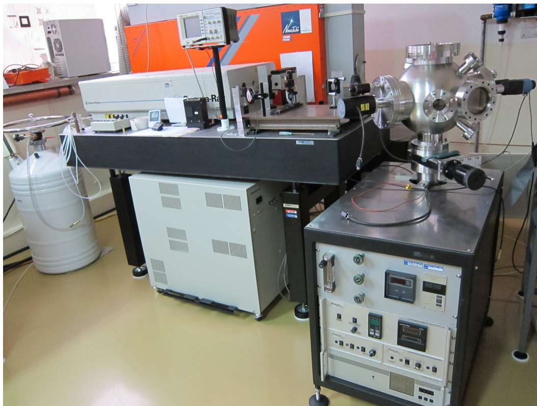
Rysunek 3.3: Zdjęcie stanowiska dla osadzania warstw metodą PLD.
