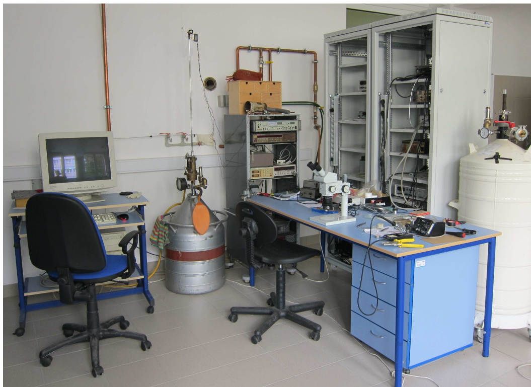
Rysunek 3.8: Zdjęcie układu pomiarowego do pomiarów bez pola magnetycznego w zakresie temperatur 4.2 \text{ K} \leq T \leq 300 \text{ K} .
