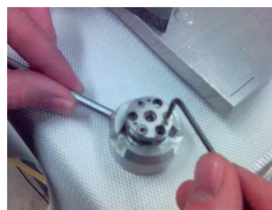
Przygotowanie pomiaru w warunkach wysokiego ciśnienia w komorze pomiarowej z kowadłami diamentowymi
