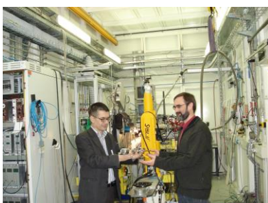
Ustawianie pomiaru dyfrakcyjnego w temperaturze 4 K (laboratorium synchrotronowe ESRF, Grenoble)
