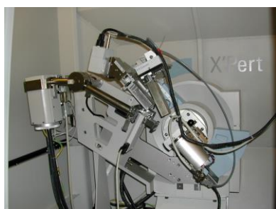
Wysokorozdzielczy dyfraktometr typu Bragga-Brentano (X'Pert) w (laboratorium SL1.3 IFPAN).
