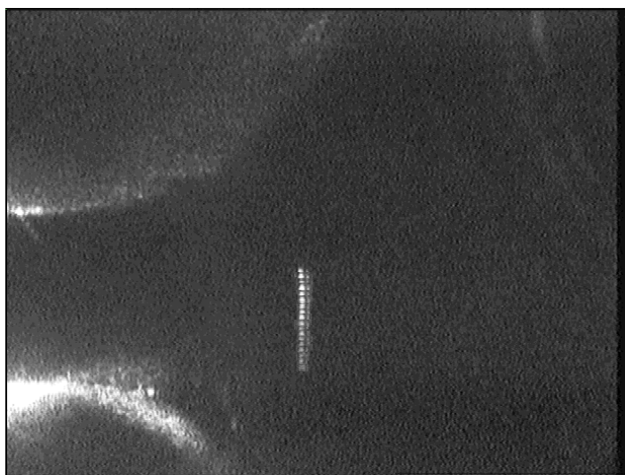
Rysunek 40: Obrazek stroboskopowy cząsteczki opadającej od momentu wyłączenia pułapkujących.
